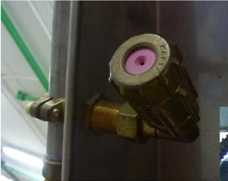
En pulverizador de barras con antigoteo controlado con presión de aire
