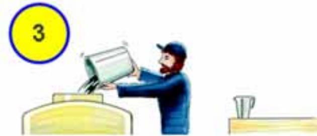
$$\frac{\text{Cantidad añadida } 153 \text{ L}}{\text{Tiempo de pulverización } 2 \text{ min} \times \text{Boquillas } 48} = 1.6 \text{ L/min por boquilla}$$
