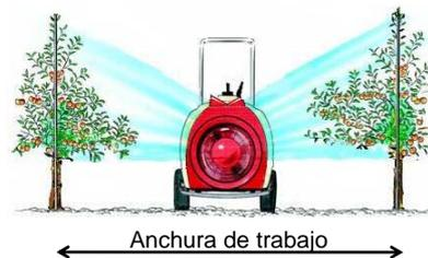
$$\frac{\text{Caudal } 1.05 \text{ L/min} \times \text{Factor } 600 \times \text{Nº boquillas } 12}{\text{Ancho trabajo } 4 \text{ m} \times \text{Velocidad } 5.0 \text{ km/h}} = 378 \text{ L/ha}$$
